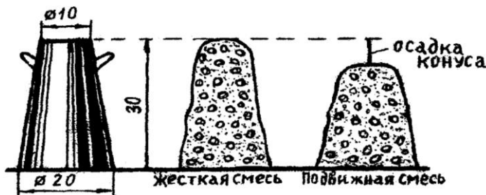
Рис. 4.5. Определение подвижности бетонных смесей
